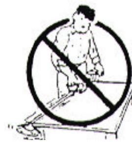
Tutte le operazioni di manutenzione, quali ingrassaggio, lubrificazione o sostituzione di organi lavoranti, devono essere effettuate con la macchina **appoggiata a terra**, il motore fermo e lo "STOP" inserito.
